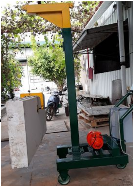
Hình 8 - Thiết bị lắp đặt panel
