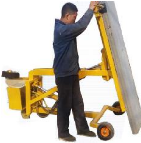
Hình 11 - Dụng cụ thủy lực lắp đặt Panel
